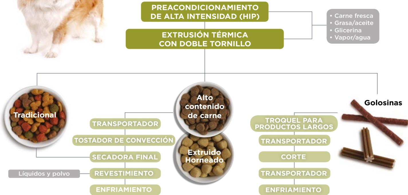
Con el nuevo **Proceso PetFlex** de Wenger puede producir alimentos estándar, inclusiones de alto contenido de carne, golosinas horneadas y productos en forma alargada para mascotas. Con base en la tecnología de extrusión térmica con doble tornillo, este proceso integral permite disminuir al mínimo los costos de energía, el desgaste y el impacto ambiental.
