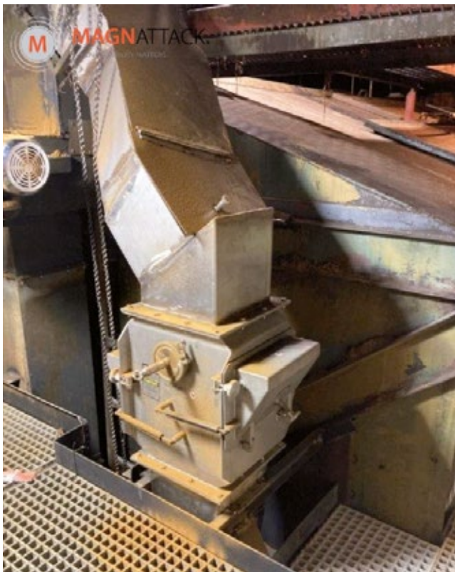
Sistema magnético de doble capa con punta redonda en renderizado
