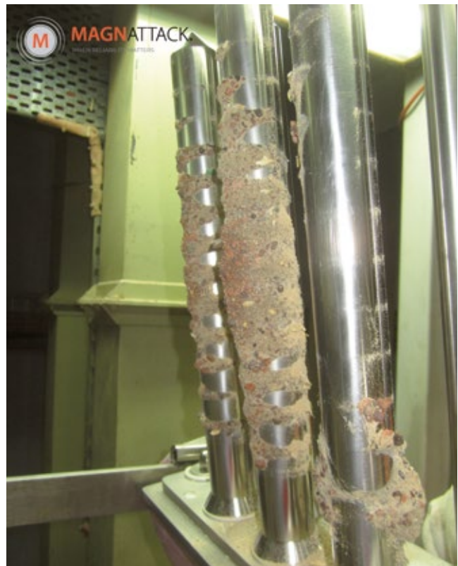
Contaminación acumulada en las barras del Rapidclean®
