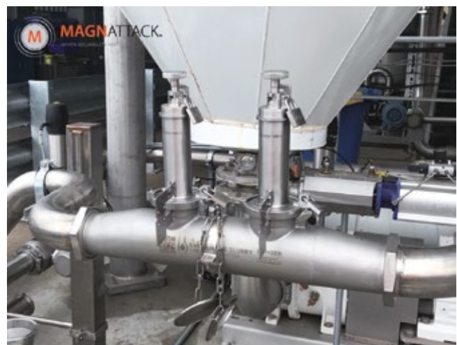
Separador para cañerías para líquidos viscosos y lodos en aplicación de productos pet food
