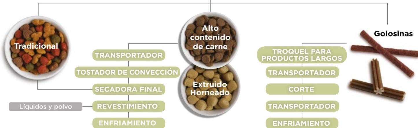
Con el nuevo **Proceso PetFlex** de Wenger puede producir alimentos estándar, inclusiones de alto contenido de carne, golosinas horneadas y productos en forma alargada para mascotas. Con base en la tecnología de extrusión térmica con doble tornillo, este proceso integral permite disminuir al mínimo los costos de energía, el desgaste y el impacto ambiental.
